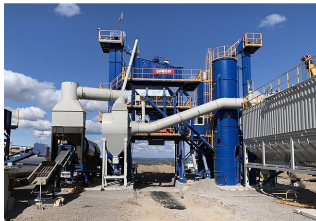
ГК «Сибиряк» г. Красноярск, Красноярский край. Мобильный асфальтобетонный завод марки Sprec.
