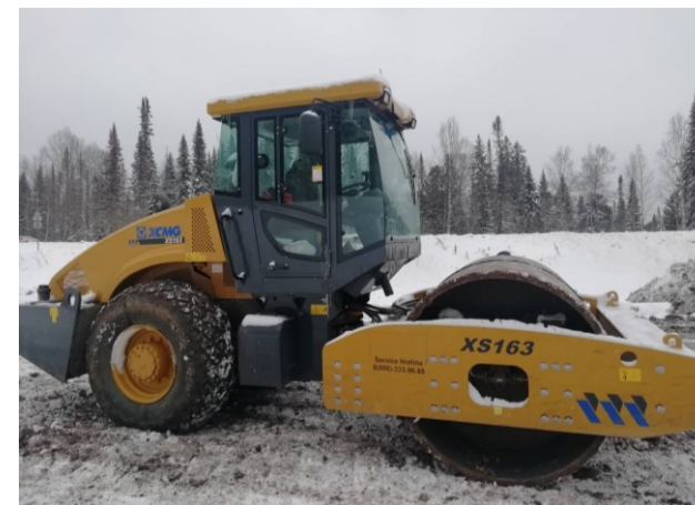
ООО «КДСК» г. Красноярск, Красноярский край. Гидравлический виброкаток XCMG XS163J.
