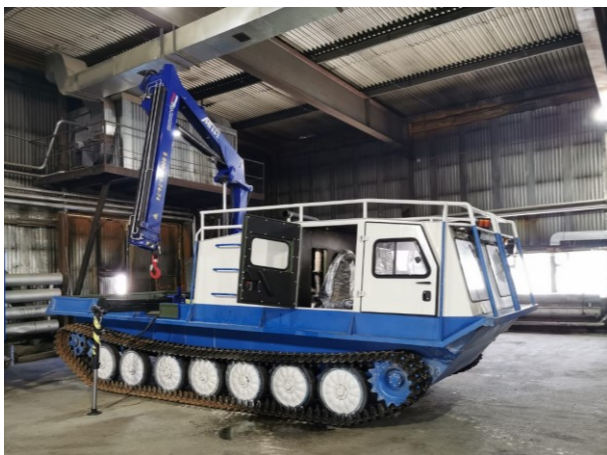
АО «ЯТЭК» г. Якутск, Республика Саха (Якутия). Гусеничный вездеход «Линкор» с КМУ.
